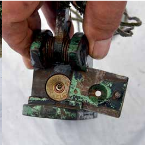
Close-up levensgevaarlijk zelfontspan schiettuig.
